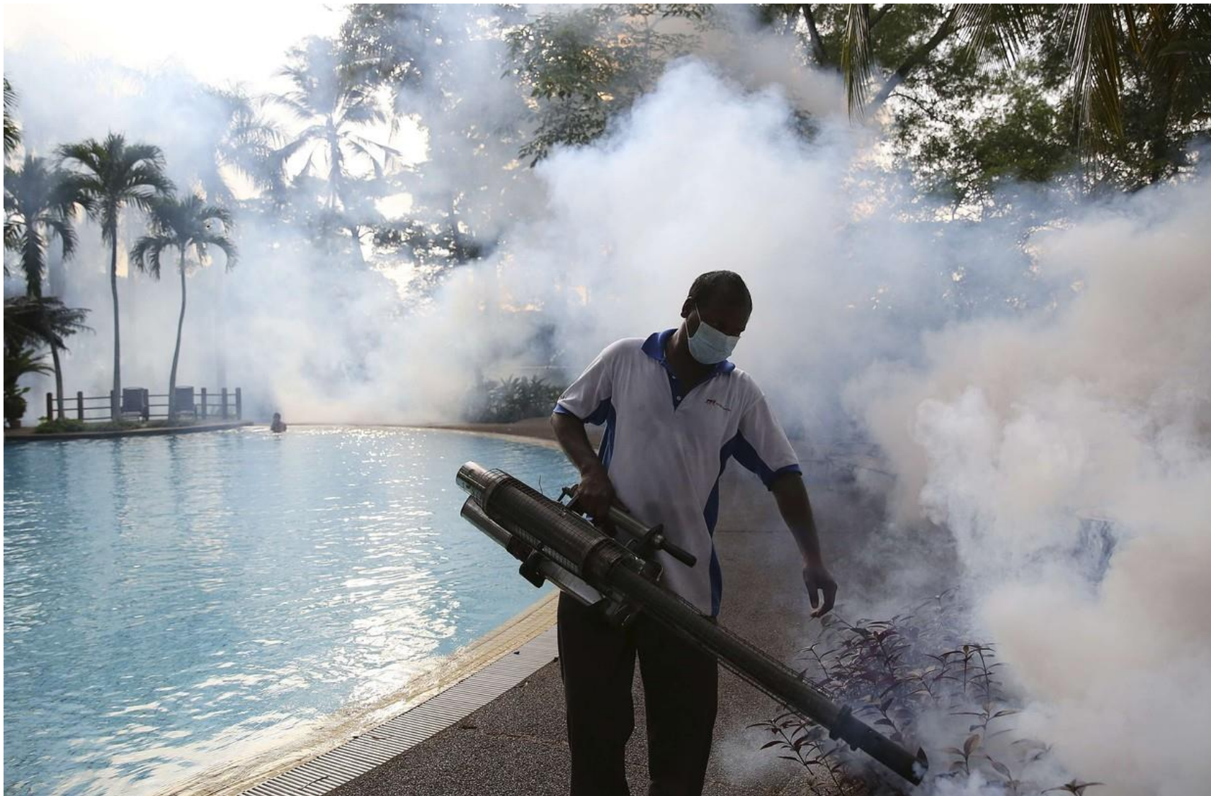
سمپاشی فضایی (بیرون اماکن) با استفاده از دستگاه ترمال فاگ دستی
