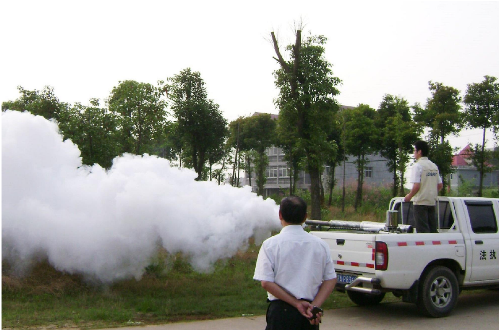
سمپاشی فضایی (بیرون اماکن) با استفاده از دستگاه ترمال فاگ ماشینی
