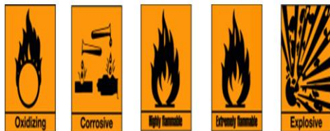
Oxidizing Corrosive Highly Flammable Extremely Flammable Explosive اکسید کننده خورنده قابلیت اشتعال زیاد بشدت قابل اشتعال قابل انفجار
